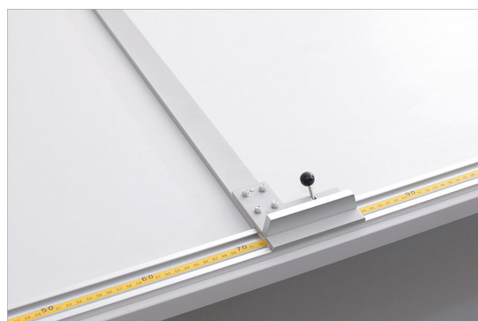
Listwa aluminiowa ułatwia odwijanie materiału do zadanej długości
